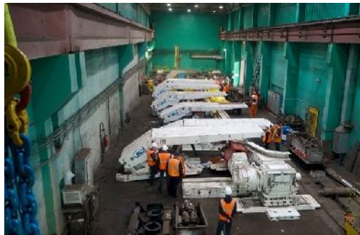
Strebausrüstung beim Versuchsaufbau (workutaugol)
