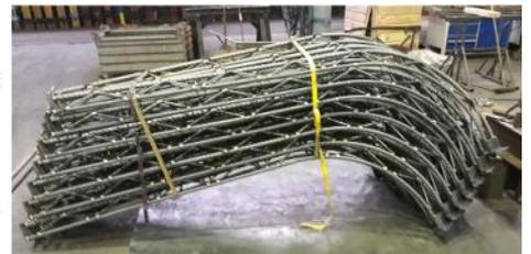
Gitterträger aus Betonstahl für das Bergwerk Merkur (Bochumer Eisenhütte)
