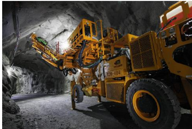
Der batteriebetriebene MacLean 975 Omnia Scaler-Bolter
